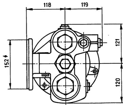
II/B Steuerventil einstufig, Personenzug, mit autom. Auslöser und Höchstdruckbegrenzer.
